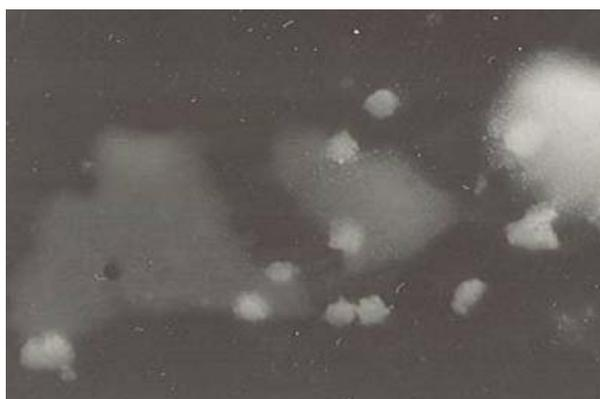
Электронномикроскопический снимок никель-молибденового катализатора (увеличение x 160 000)
