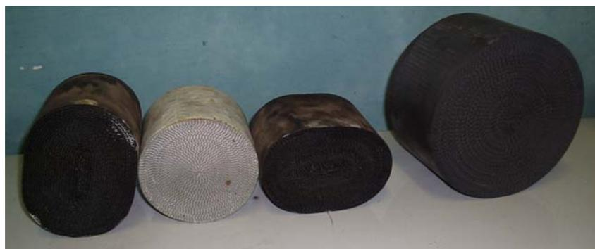
Рис. 1. Металлические блочные катализаторы
