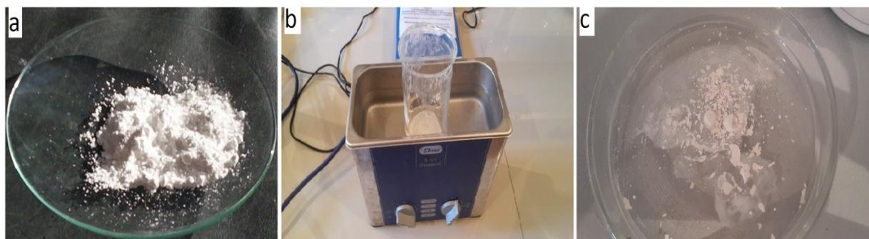
Рисунок 2 - а) – гранулы  $\text{TiO}_2$ ; б) – полученный раствор подвергали воздействию ультразвука (Elmasonic S) в ванне; в) – полученный осадок (наноразмерный  $\text{TiO}_2$ )
