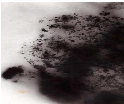
2 сурет - 5%MoCrGa/ТБ+ИК-30 өңделген катализатордың электрондық микроскоп суреті. GaO 2 H (ASTM, 6-180), α-GaOOH (ASTM, 26-674), Mo 3 O 5 (ASTM, 20-754).
