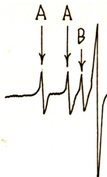
2-сурет – 80% ТГФ + 20% ДО араласқан еріткішінде нафталин АР шеткі ЭПР спектрі. – 10 0 С температурада жазылған. А – иондық жұп ТГФ молекуласымен сольватталған, В – иондық жұп ДО молекуласымен сольватталған
