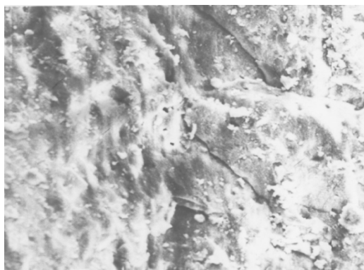
Рисунок 5-Электронно-микроскопический снимок -γ-Al 2 O 3
