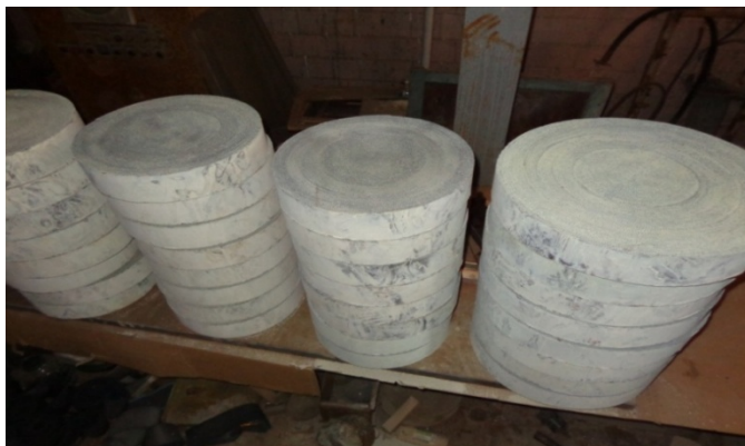
Рисунок 1 – Металлические блоки с нанесенным вторичным носителем ПТ 16/150, ПТБ/10/64
