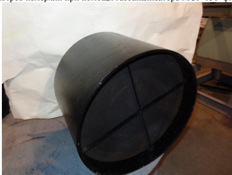
Рисунок 3 - Блочный каталитический нейтрализатор для нейтрализации токсичных выбросов печи подогрева нефти ПТ 16 /150
