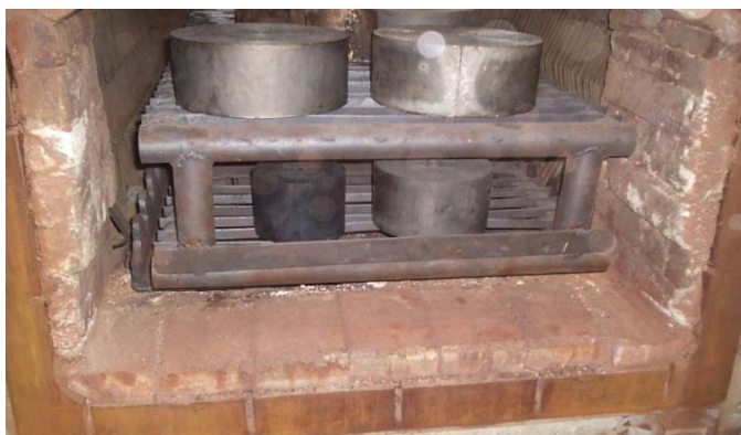
Рисунок 2 - Электрическая печь для обжига металлических блочных катализаторов на опытно-экспериментальном участке АО «ИТКЭ»
