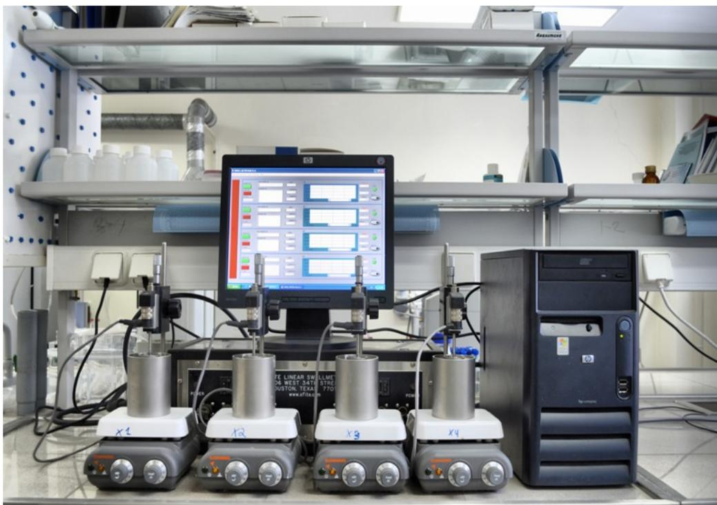
Рисунок 1 – Тестер продольного набухания в динамическом режиме
