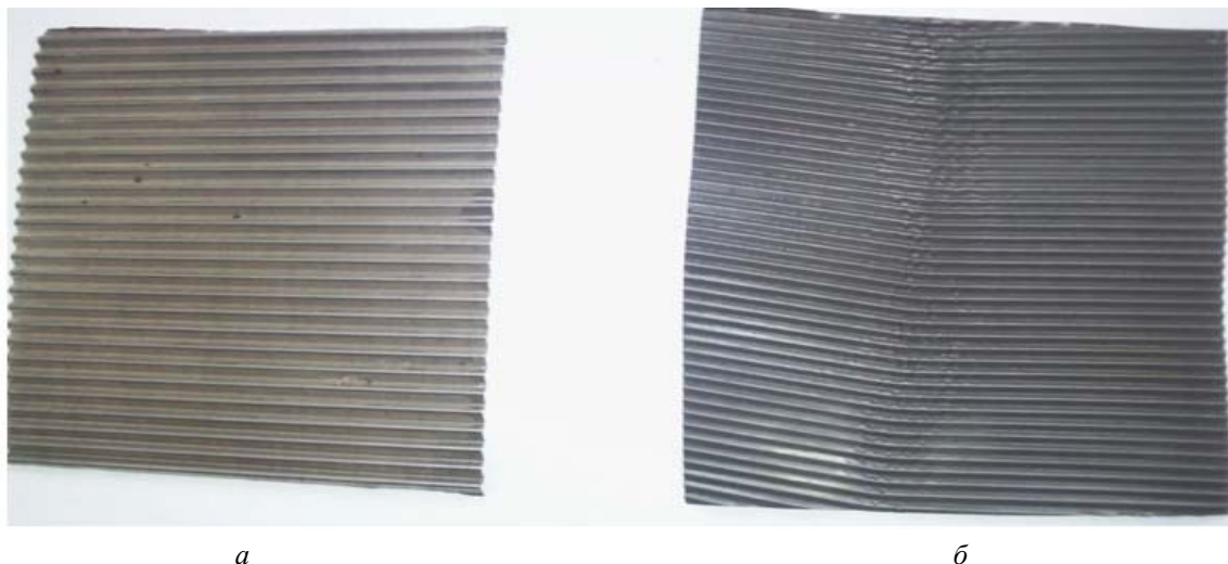
1-сурет – Гофрленген фольга үлгілері: a – қарапайым типті каналды фольга; б – «шеvron типті» каналды фольга
