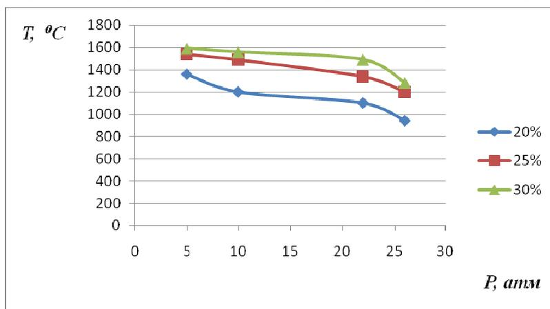
Рисунок 1 – Зависимости температуры горения от давления азота в системе Al – TiO<sub>2</sub> – C – N<sub>2</sub>
