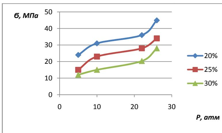
Рисунок 2 – Зависимости прочности образцов от давления азота
