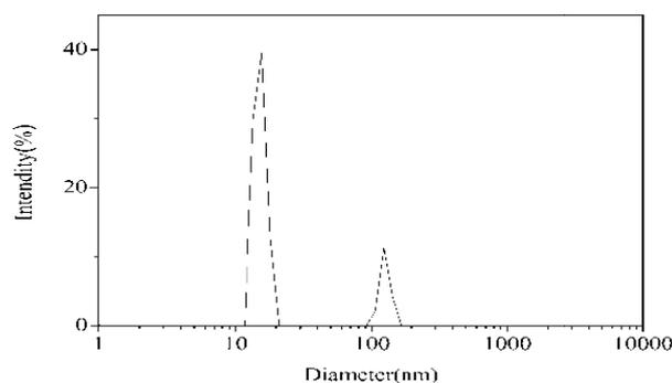
Рисунок 1 – Размер наночастиц железа в синтезированном катализаторе  $Fe_3O_4$
