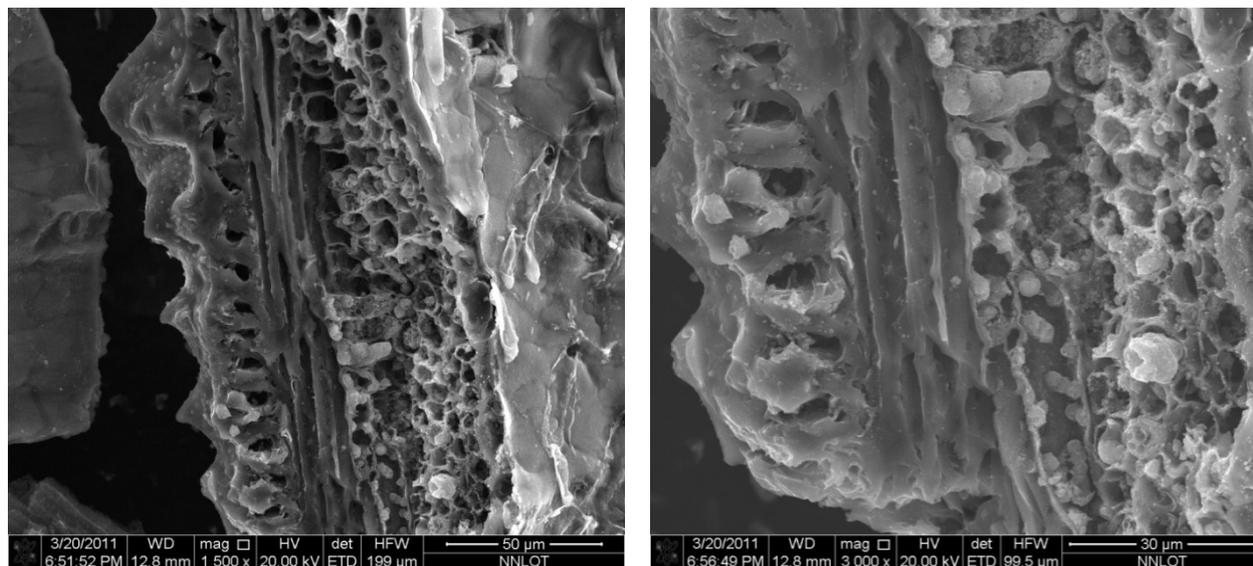
Рисунок 2 – СЭМ снимки рисовой шелухи после термообработки
