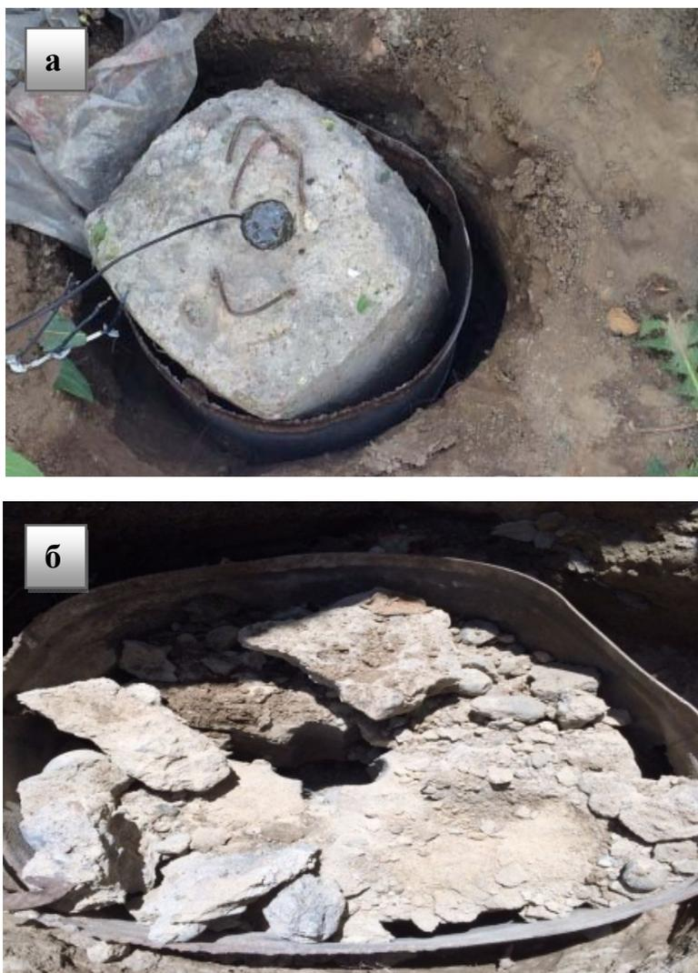
Рисунок 1 – Разрушения бетонных блоков закрытыми броневой оболочкой:
