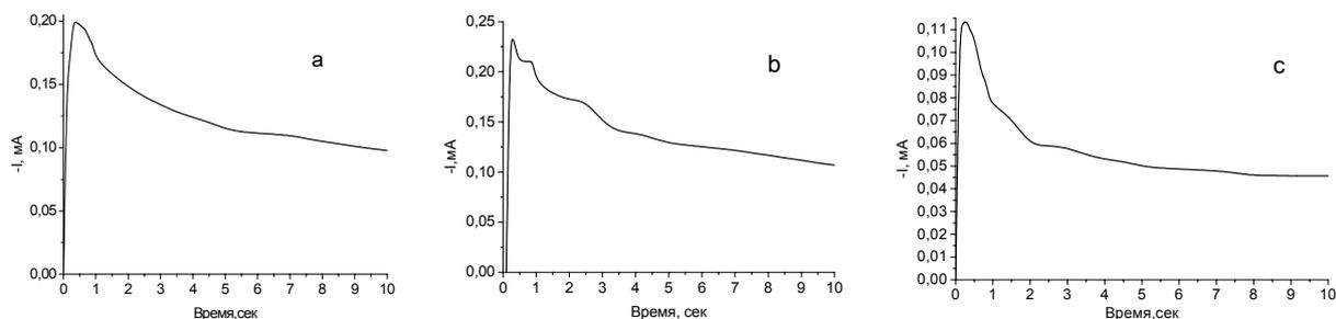
Рисунок 2 – I-t кривые электроосаждения ионов  $\text{Cd}^{2+}$  (0,01M) из электролитов на основе сульфосалициловой (a, b) и серной (c) кислот при 25°C при потенциалах (a) -0,8В, (b) -0,85В и (c) -0,75В
