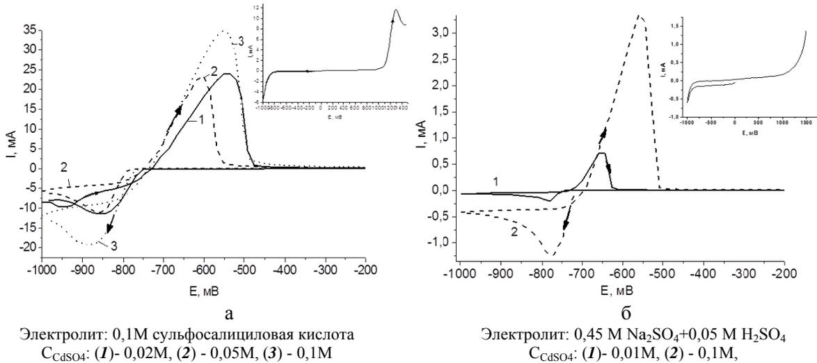
Рисунок 1—ЦВА стеклоглеродного электрода ( $S=0,07cm^2$ ) при  $25^\circ C$ , снятые со скоростью циклирования  $v=20$  мВ/с, при осаждении кадмия(а) в сульфосалициловой кислоте, (б) в сернокислом электролите. На врезках представлены соответствующие фоновые кривые
