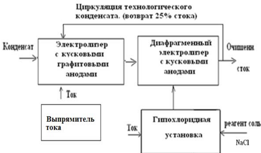
Рисунок 1 – Усовершенствованная принципиальная технологическая схема проведенного пилотного испытания
